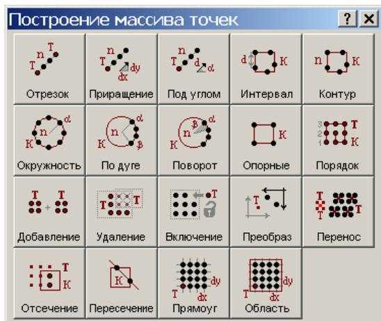
После выбора варианта построения на экране появится пиктограмма выбранного варианта построения (если в меню **Настройка** включен пункт **Схема**) и панель **Параметры** для задания параметров опорных геометрических элементов, по которым строится требуемый элемент.
