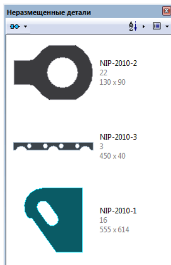
Рисунок 18. Панель «Неразмещенные детали»
