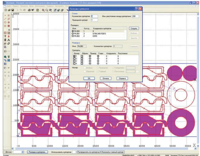
При программировании обработки требуемая разводка суппортов выполняется автоматически.
