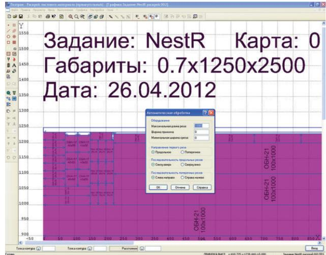
Управляемая автоматическая обработка. При работе по этой схеме программа определяет положение на листе всех возможных линий сквозного реза. От пользователя требуется последовательно выбирать нужные варианты. Такой подход обеспечивает полный контроль программирования обработки, исключая ошибочное зарезание деталей и отслеживая полноту задания всех резов.
