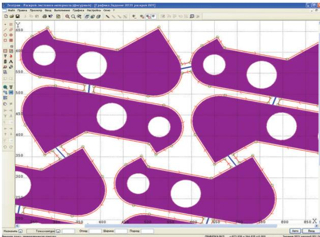
**Строгий контроль перемещения деталей.** Включение этой функции позволяет перемещать детали по листу на экране монитора, как реальные предметы, для которых другие детали и край листа являются непреодолимым препятствием.
