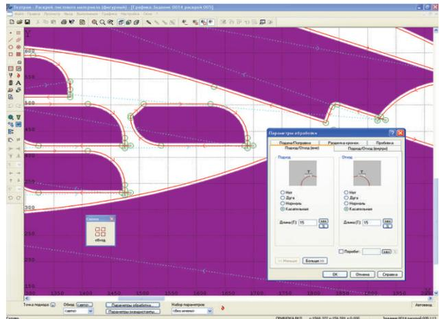
**Обработка вручную.** Для нестандартных случаев существует возможность построения траектории и задания технологических команд в явном виде.
